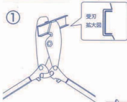
① ハンドルを開き、切断するチャンネルに対して、90°になるようカッターをセットします。
